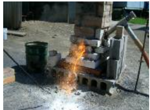
4時間後炉から流れたすノ口(鉄の不純物)。
